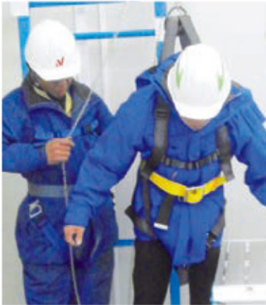
宙吊りになった状態で 「墜落制止用器具」の有用性を確認する様子
